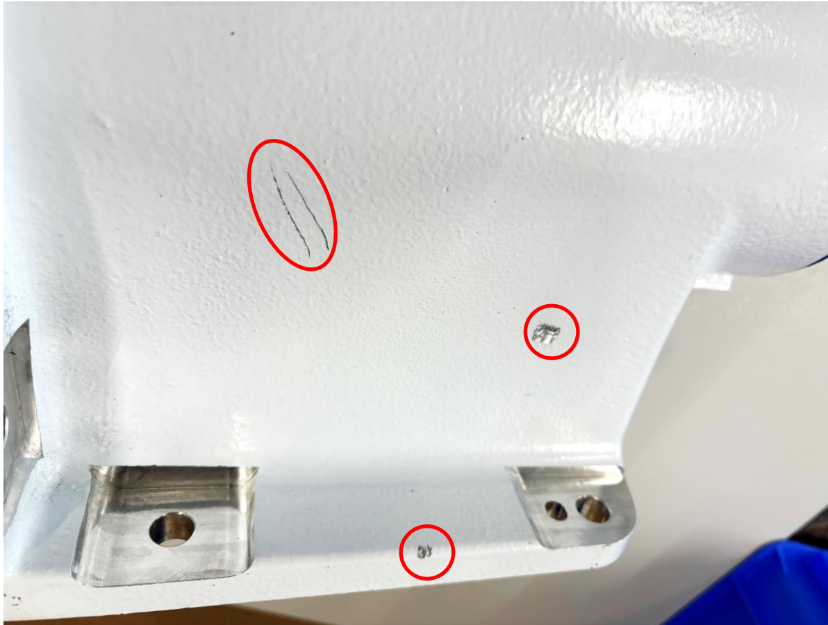
Reparable Fehlstellen (beispielhaft): Kratzer, kleine Abplatzungen
